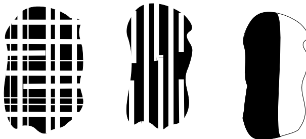
Fig. 16 - Tipuri de macle (imagine la microscop)
