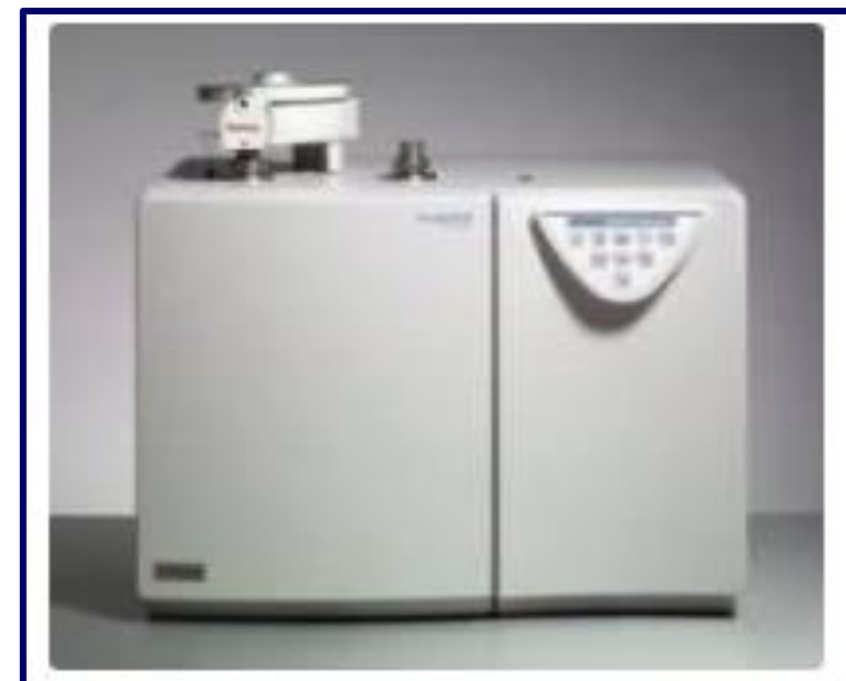
Analizor FlashEA 1112, pentru C,H, N
