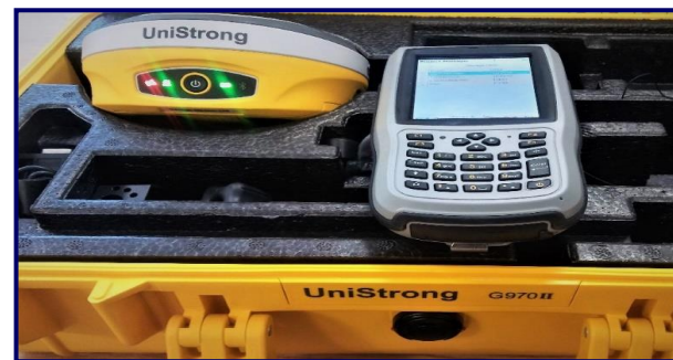
GPS cu Coordonate Stereo 70, precizie \pm 0,003 m Nord, Est + elevatie
