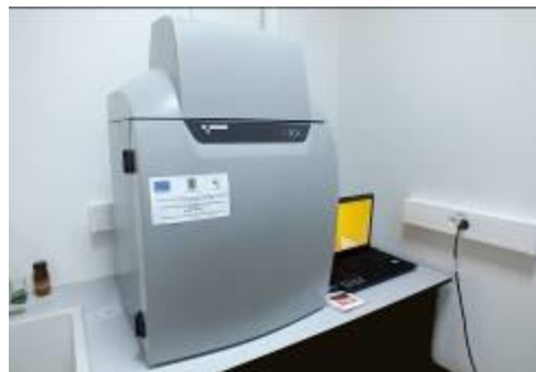
Sistem de fotodocumentare Syngene GBOX Chemi XRQ
