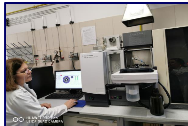
spectrometru AAS cu cuptor de grafit
