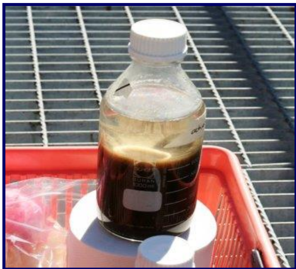
Colectarea probei de nămol în vederea analizei microbiologice
