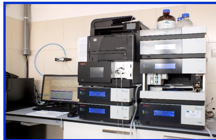
Cromatograf de lichide cu detector cu florescenta
