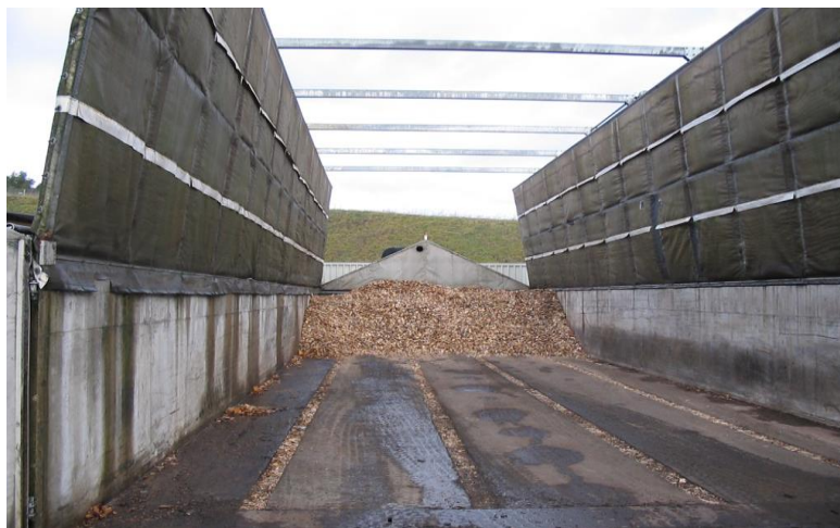
Figura 11.36 Vedere sistem aerare prin podea protejat cu ajutorul rumegusului
