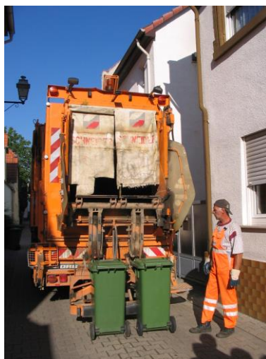
Fig. 9.13 - Sistem hidraulic de ridicare si rasturnare pentru preluarea cu pieptene sau cu fus
