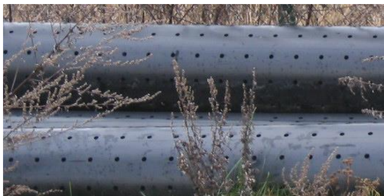
Figura 13.5 - Vedere tevi de colectare a levigatului
