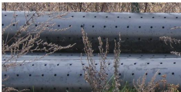
Figura 7.5 - Vedere tevi de colectare a levigatului
