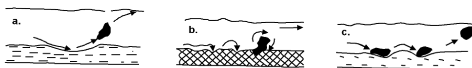
Fig. 48 - Urme lăstate de particule prin: a. - târâre b. - rostogolire c. - saltație
