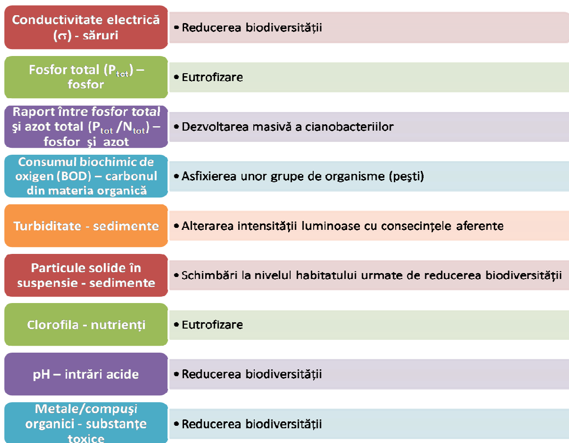
Fig. 5.1 Reprezentare schematică a indicatorilor generali și a efectelor acestora identificate în monitoringul stării de calitate a ecosistemelor acvatice
