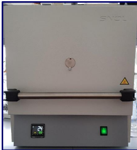
Cuptor calcinare probe
